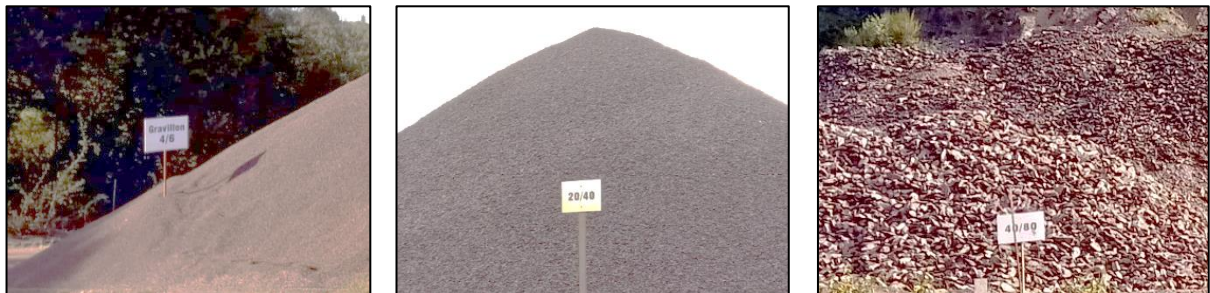
Figure 6 : Exemple de coupes granulométriques commercialisées
